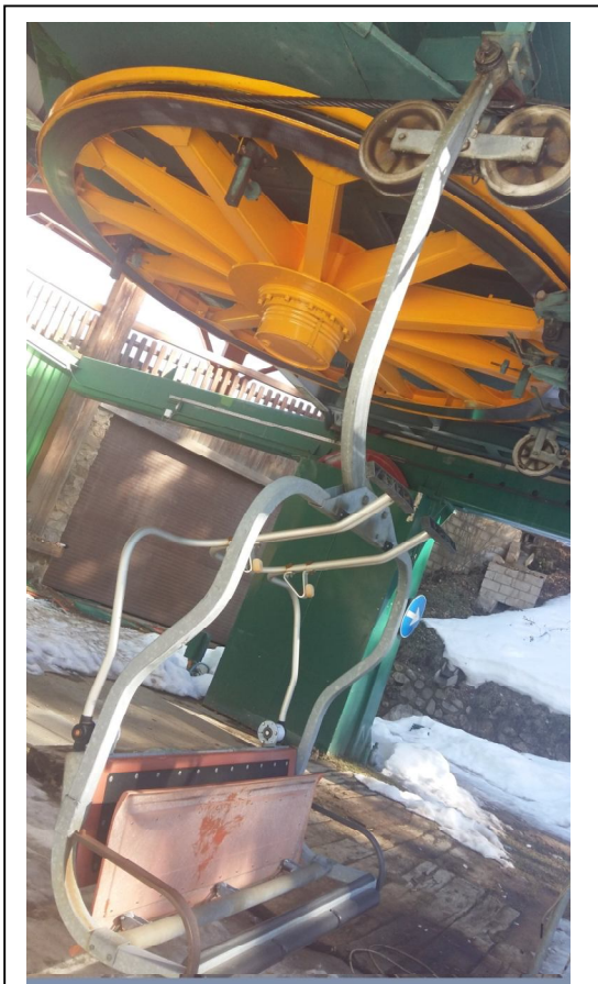
Fig. 7 - Apparato ed assieme meccanico composto dalla puleggia e cavo di acciaio che garantisce il funzionamento dell'impianto di risalita della seggiovia
